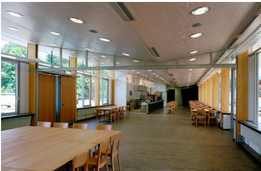
Die Leichtmetallfassade des Restaurants mit einer Kombination von feingliedrigen Fenstern und grossen Holzpaneelen. Das weit ausladende Dach schwebt über dem durchlaufenden Glasoberlichtstreifen.
